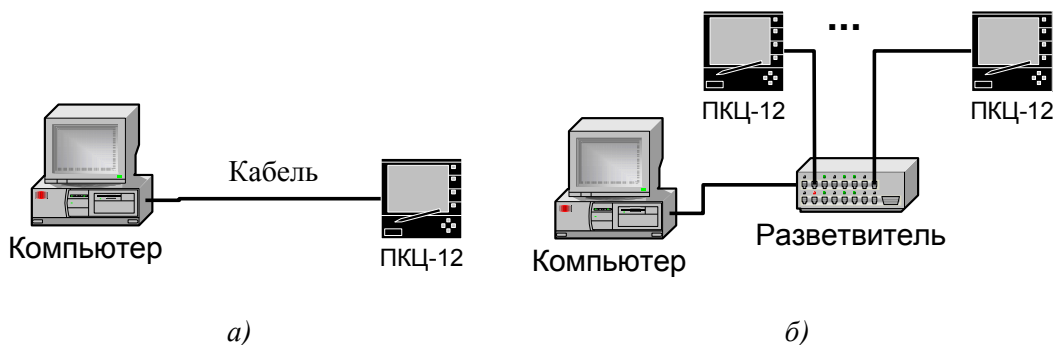
Рисунок 7 - Подключение ПКЦ-12 к компьютеру через RS-323C а) индивидуальное; б) групповое
